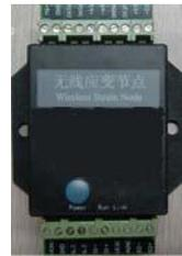
节点结构紧凑，体积小巧，由电源模块、采集处理模块、无线收发模块组成，封装在 Ryton PPS 塑料外壳内。节点每个通道内置有独立的高精度 120-1000  $\Omega$  桥路电阻和放大调理电路，可以方便地由软件自动切换选择 1/4 桥，半桥，全桥测量方式，兼容各种类型的桥路传感器，比如应变，载荷，扭距，位移，加速度，压力，温度等。节点同时支持 2 线和 3 线输入方式，桥路自动配平。采集的数据既可以实时无线传输至计算机，也可以存储在节点内置的 2M 数据存储单元，保证了采集数据的准确性。节点的空中传输速率可以达到 250K BPS，有效室外通讯距离可达 1Km。节点设计有专门的电源管理软硬件，在实时不间断传输情况下，节点功耗仅 25mA，使用内置的可充电电池，可连续测量十几个小时。如果选择带有 USB 接口的节点，您既可以通过 USB 接口对节点充电，也可以快速地把存储器内的数据下载到计算机里面。
